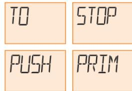
Figure 3-13 **TO STOP PUSH PRIM** (para detener, presione cebar)
